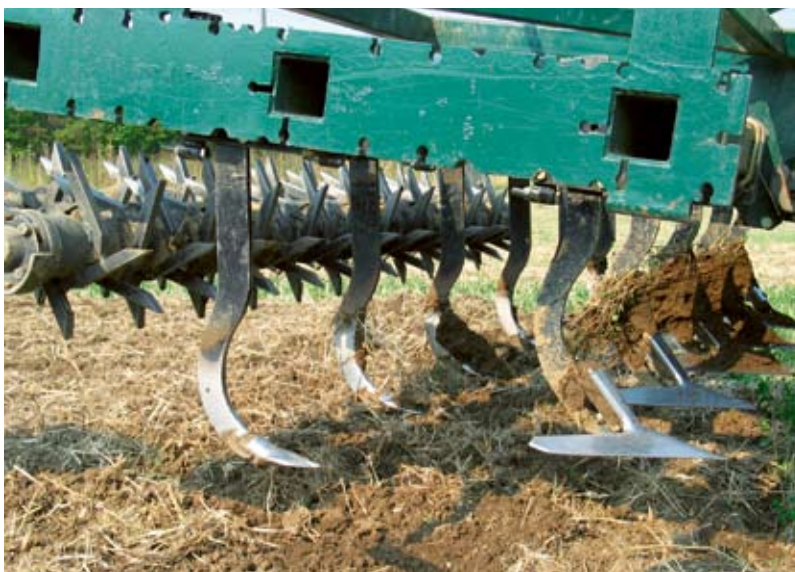
Als Alternative zum Schälplflug kommt auch der Ecodyn-Grubber in Frage. Seine Flügelscharen durchschneiden den Boden ganzflächig und die Arbeitstiefe kann über Stützräder eingestellt werden. Er führt jedoch zu einer größeren Durchmischung des Bodens als der Schälplflug.
