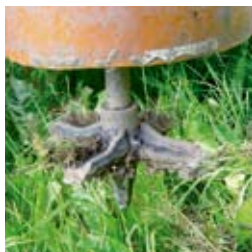
Der Fräskopf der neuen Wuzi-Generation arbeitet sich in die Ampferpflanze und zerstört die Wurzel. Er hat sich im professionellen Betrieb bewährt.
