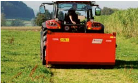
Für die Beseitigung der Ampferständer wurde ein Mulchgerät mit Auffangwanne entwickelt.
