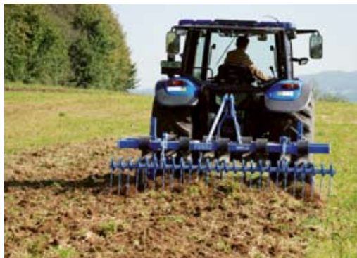
Für die pfluglose Grünlanderneuerung leistet der Flachgrubber gute Arbeit. Die Scharen durchschneiden den Boden ganzflächig und der nachfolgende Schwerstriegel löst die Wurzelstöcke von der Erde.
