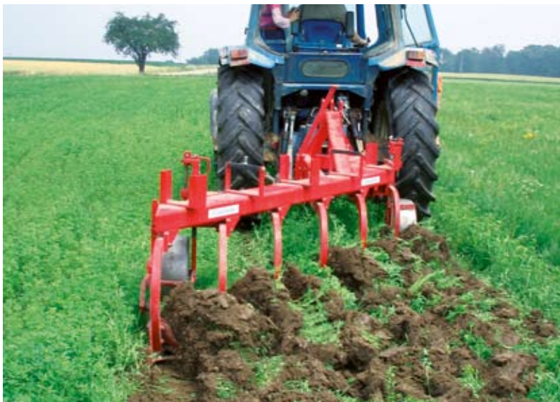
Der Schälplflug (im Bild der Stoppelhobel) ermöglicht mit Hilfe des Stützrads eine genaue, oberflächliche Bodenbearbeitung.
