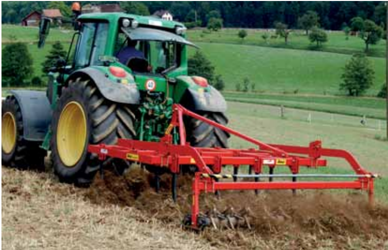
Dieser Grubber mit Doppelsternwalze ist eine Alternative zur Scheibenegge. Er kann den Boden tief lockern und flach bearbeiten. Als Option kann dieses Gerät auch mit Stroheinleger und Striegel für eine optimale Stroheinmischung ergänzt werden.
