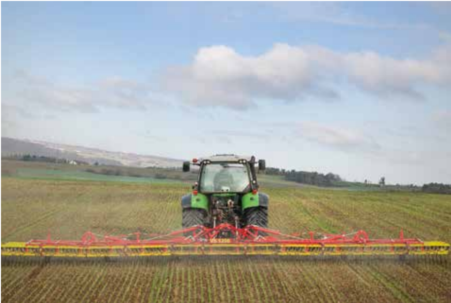
Beim neuen Variostriegel der Firma APV kann mit einem Steuergerät am Traktor der Striegelzinkendruck am ganzen Gerät verändert werden
