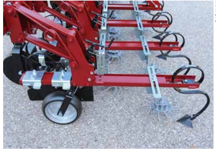
Die Kunststoffsterne werden durch Metallsterne mit schleppend angeordneten Fingern ersetzt
