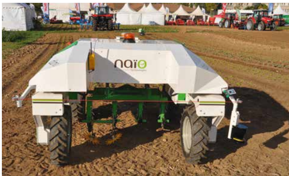
Der Roboter naïo dino kann sich auf Gemüsebeete mittels Sensoren und GPS selber zurechtfinden und hacken
