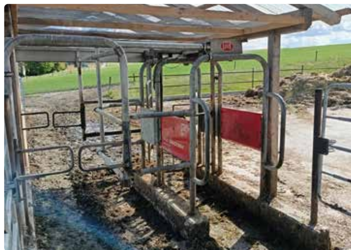
Weideselektionstore sind AMS gesteuert, um den Weidegang in Abhängigkeit des Melkanrechts zu steuern © Rudlstorfer, LK OÖ
