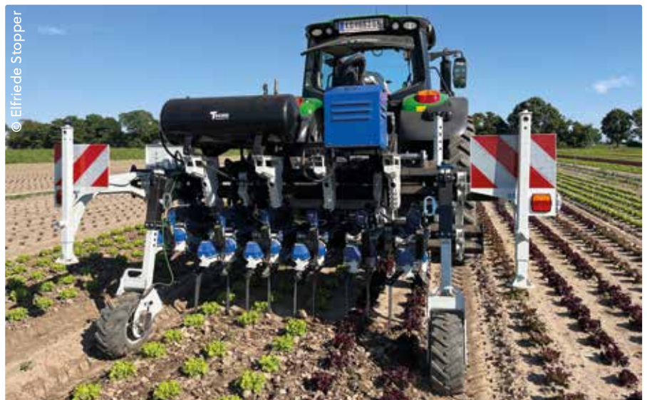
Die Kamerasoftware erkennt die Kulturpflanze und öffnet dort mit einem einstellbaren Sicherheitsabstand ihre Messer. Nach Herstellerangaben können bei gut etablierter In-Row Hacktechnik 90 % der Handhackkosten eingespart werden.
