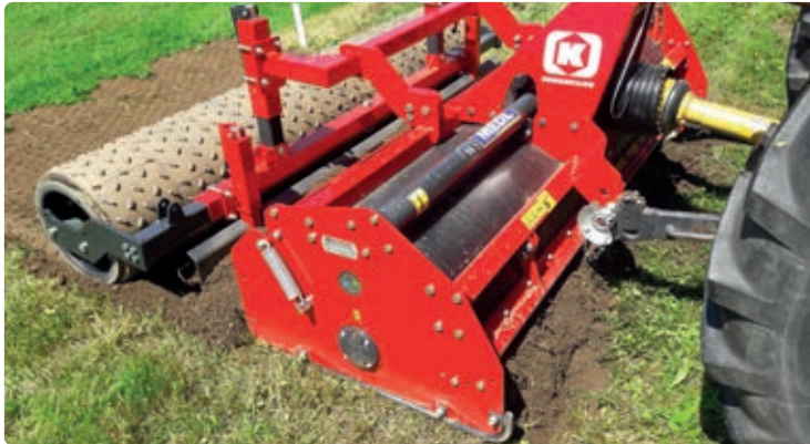
Abb. 3: Die Rotorumkehregge arbeitet mit entgegen der Fahrtrichtung rotierenden Werkzeugen. Das feine Material wird an der Oberfläche ablegt und damit ein feines Saatbett geschaffen.
