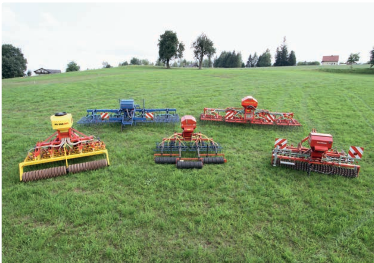
Abb. 1: Nachsaatgeräte mit (vordere Reihe) und ohne (hintere Reihe) Walzen zum Andrücken des Saatguts
