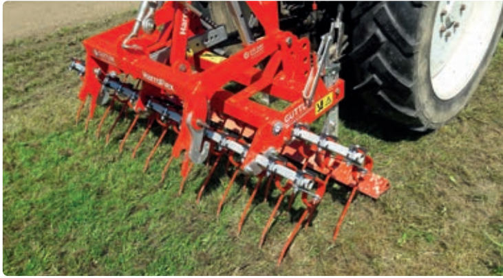
Abb. 2: Der Starkstriegel ist die günstigste Methode zur Saatbettvorbereitung. Er öffnet den Boden intensiv und bringt die Saat schnell aus. Es verbleibt jedoch ein höherer Restbestand der Altnarbe.
