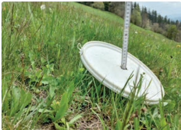
Abb. 11: Bestimmung der Deckelhöhe in cm mittels Zollstab (Foto: Angeringer).
