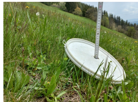
Aufwuchshöhenmessung: Ein- und Austrieb
