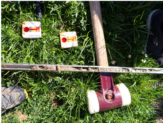
Feldbodenkundliche Untersuchungen: Bodenstich, Schätzung pH-Wert Ober- und Unterboden, Profilbeschreibung, Bodenart - Fingerprobe
