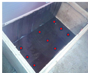
Abb.2: Messung der Temperaturverteilung mittels 9 Sensoren
