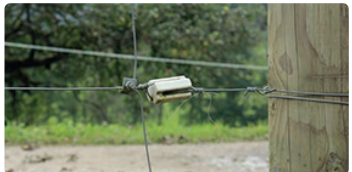
Halteisolatoren müssen Zugkräfte des Zauns aufnehmen können.
