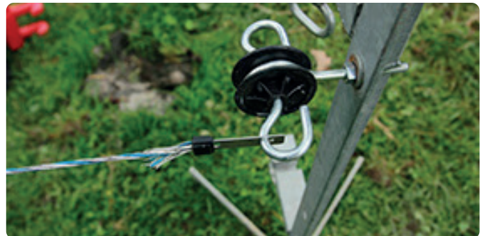
Bei Kurzschluss des Zauns dürfen an der Erdungsanlage höchstens 600 Volt messbar sein.
