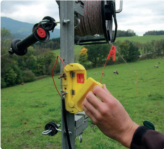
Krokodilklemme zum Zaunanschluss und Zaunschalter
