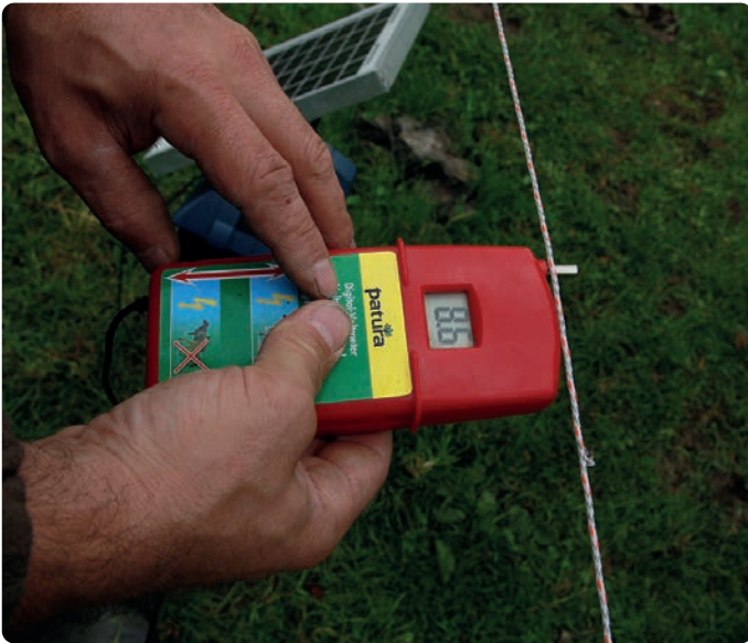
Zaunspannung ohne simulierter Tierberührung
