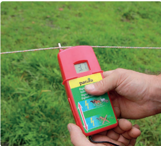
Zaunspannung mit simulierter Tierberührung
