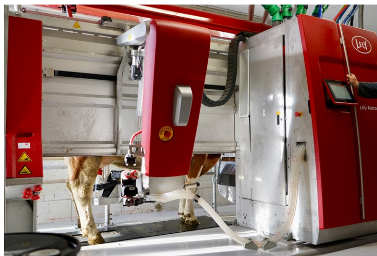
Im Melkroboter braucht es meist keine besonderen Anpassungen für horntragende Milchkühe, im Ein- und Ausgangsbereich sollte man auf ausreichend Platz achten.
