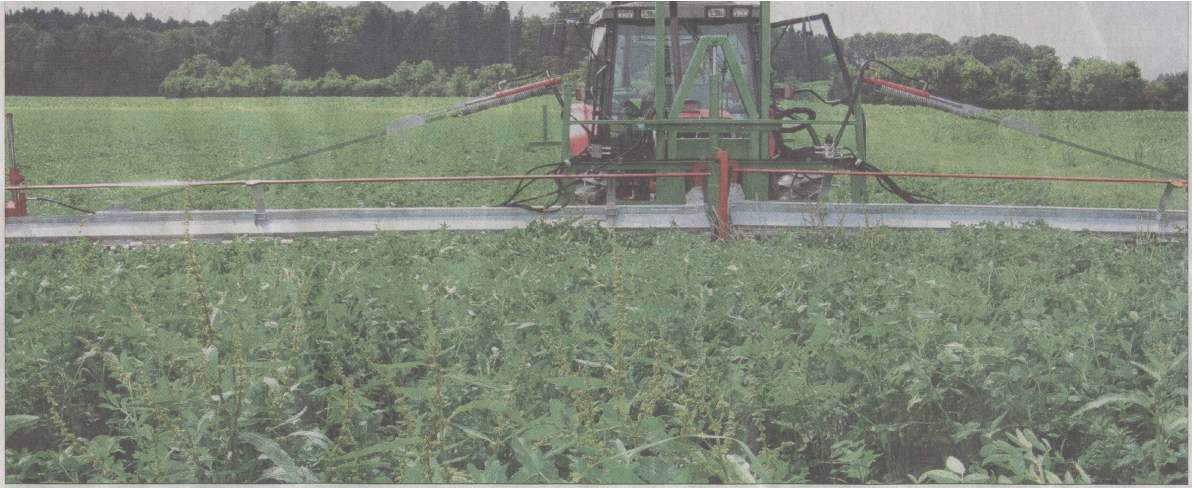
Ob Strumpfen, Disteln oder sonstige Beikräuter – alles was über die gewünschte Erntefrucht wächst, wird von dem Unkrautbomber geköpft.
